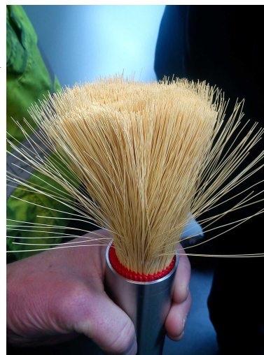
Varje membran är uppbyggt av flera hundra tunna ihålliga fibrer.
